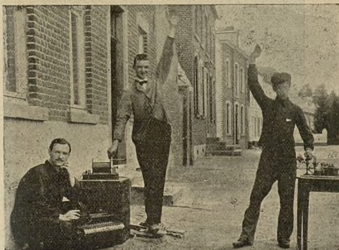
Fig. 22. —Telégrafo sin hilos empleando el cuerpo humano como antena nera que el cuerpo hace el papel de conductor y condensador. En la fig. 23 se ve el experimento que hizo para estudiar la ac-
