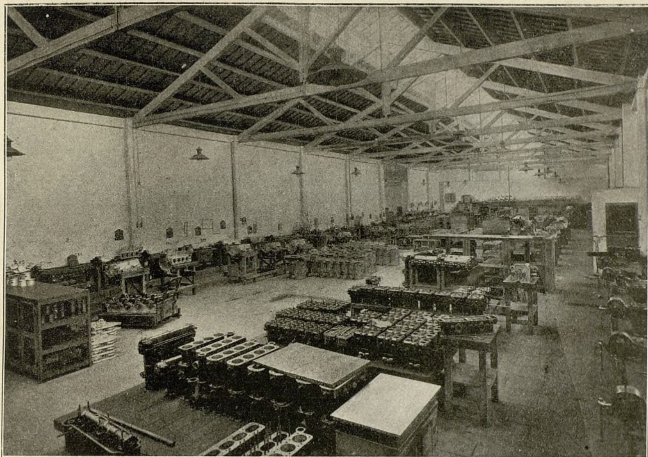
La Hispano Suiza. —Montaje de motores.
