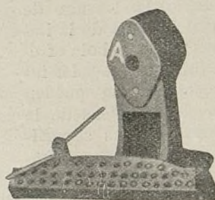
Pieza A perforada en el lugar que ocuparán los torillos de ensamblado; en dichas perforaciones pueden verse las probetas antes de ser extraídas.
