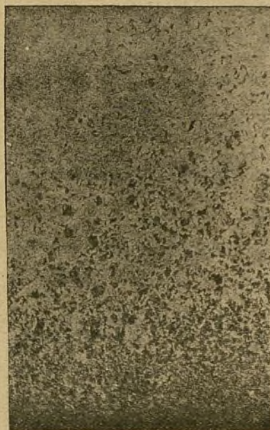
Acero al 0,6 % de cromo cementado a 950° cent. durante dos horas Aumento: 50 veces.
