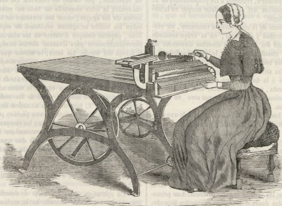
Teciados mecánicos del Capitan Rosemberg.—(Fig. 2.ª Máquina de distribuir.)
