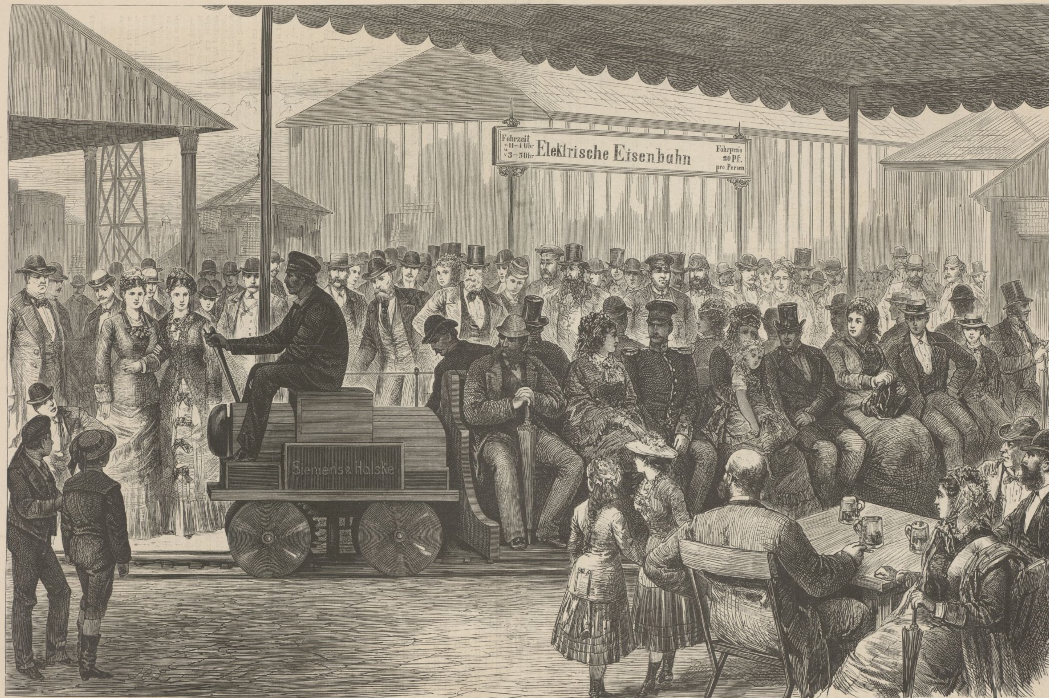
Von der berliner Gewerbeausstellung: Die dynamo-elektrische Eisenbahn von Siemens u. Halske. Originalzeichnung von H. Lüders.
