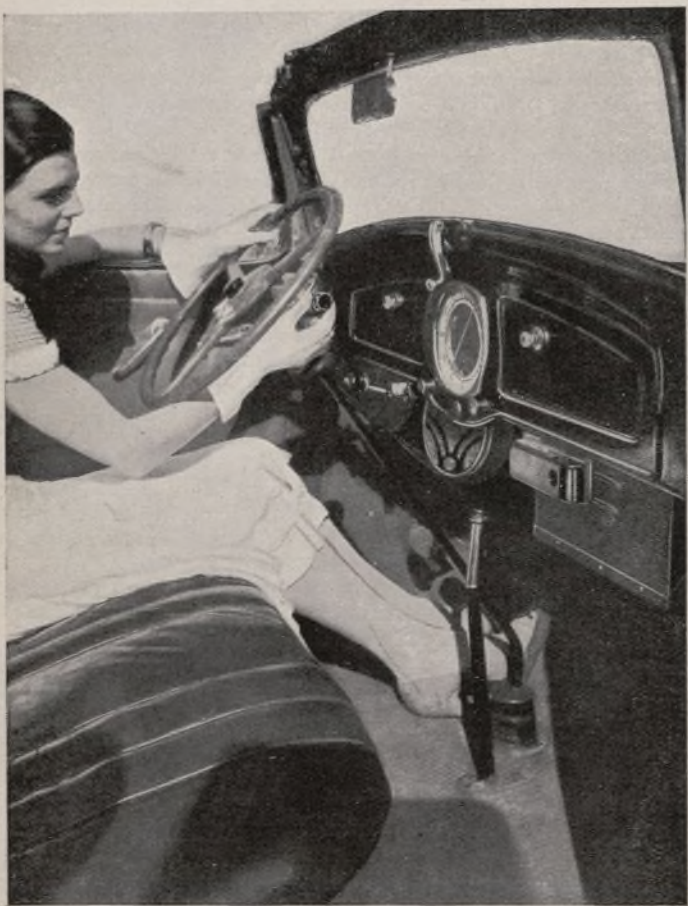
Una moderna instalación de radio en un automóvil: El mando, en el volante; el altavoz, en el centro, y el aparato, a la derecha.
