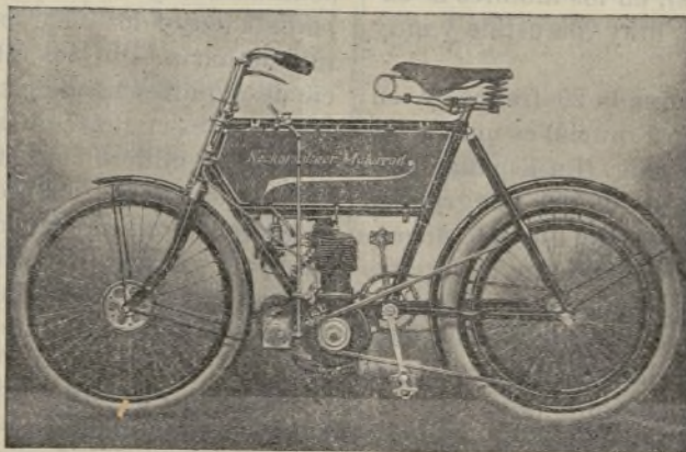
Motocicleta N. S. U., modelo 1904, con allumaje electro-magnético, motor y carburador N. S. U.
