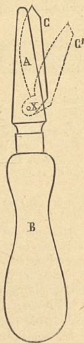
Figura 5.ª — Instrumento para afilar el extractor de gas Coscera.
