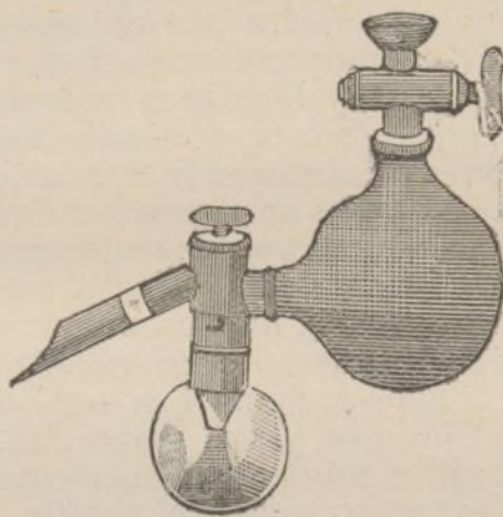
Fig. 3. — Cambios introducidos recientemente en la anterior por el mismo Thompson. Le represento en el acto de funcionar con objeto de que se vea el movimiento que toman las arenas al descender á la ampolla de cristal.
