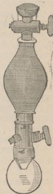
Fig. 2. — Primera bomba aspiradora de Thompson.
