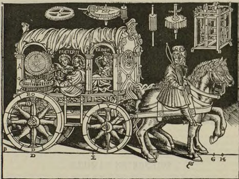
Compteur kilométrique des anciens appliqué à une voiture, d'après les œuvres de Vitruve, imprimées à Venise en 1521.
