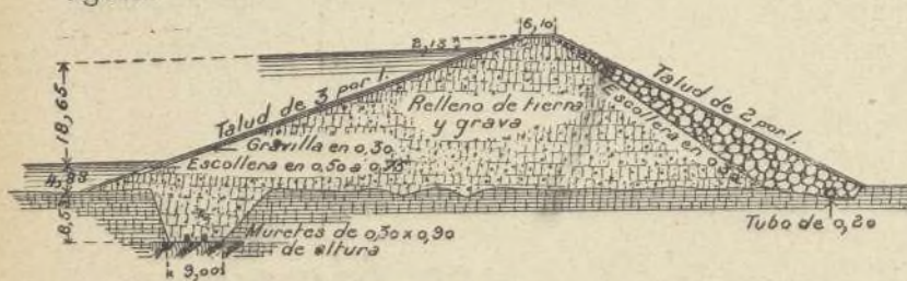
Sección transversal de la presa Cold Springs.
