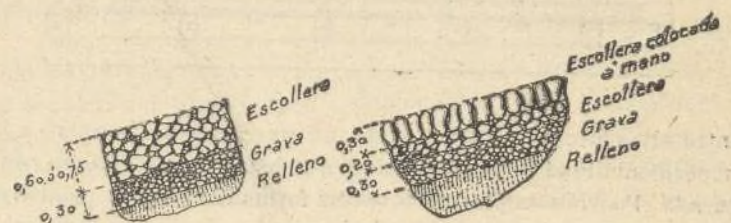
Revestimientos en el talud interior de las presas.
