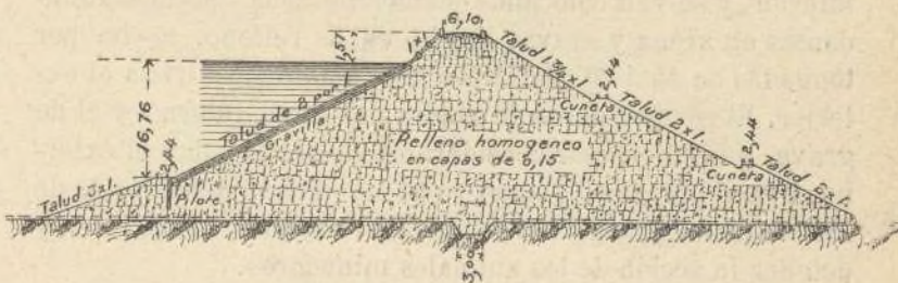
Sección transversal de la presa de Belle Fourche.
