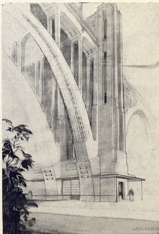
Detalle de una pila con ascensor y arranque de los arcos.
