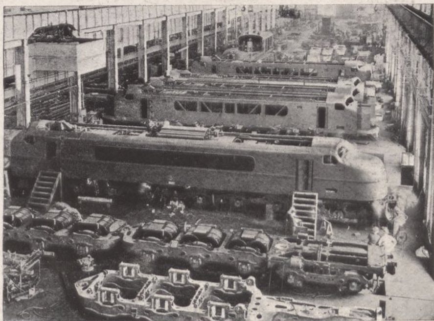
Construcción de locomotoras en una gran fábrica del Este norteamericano
