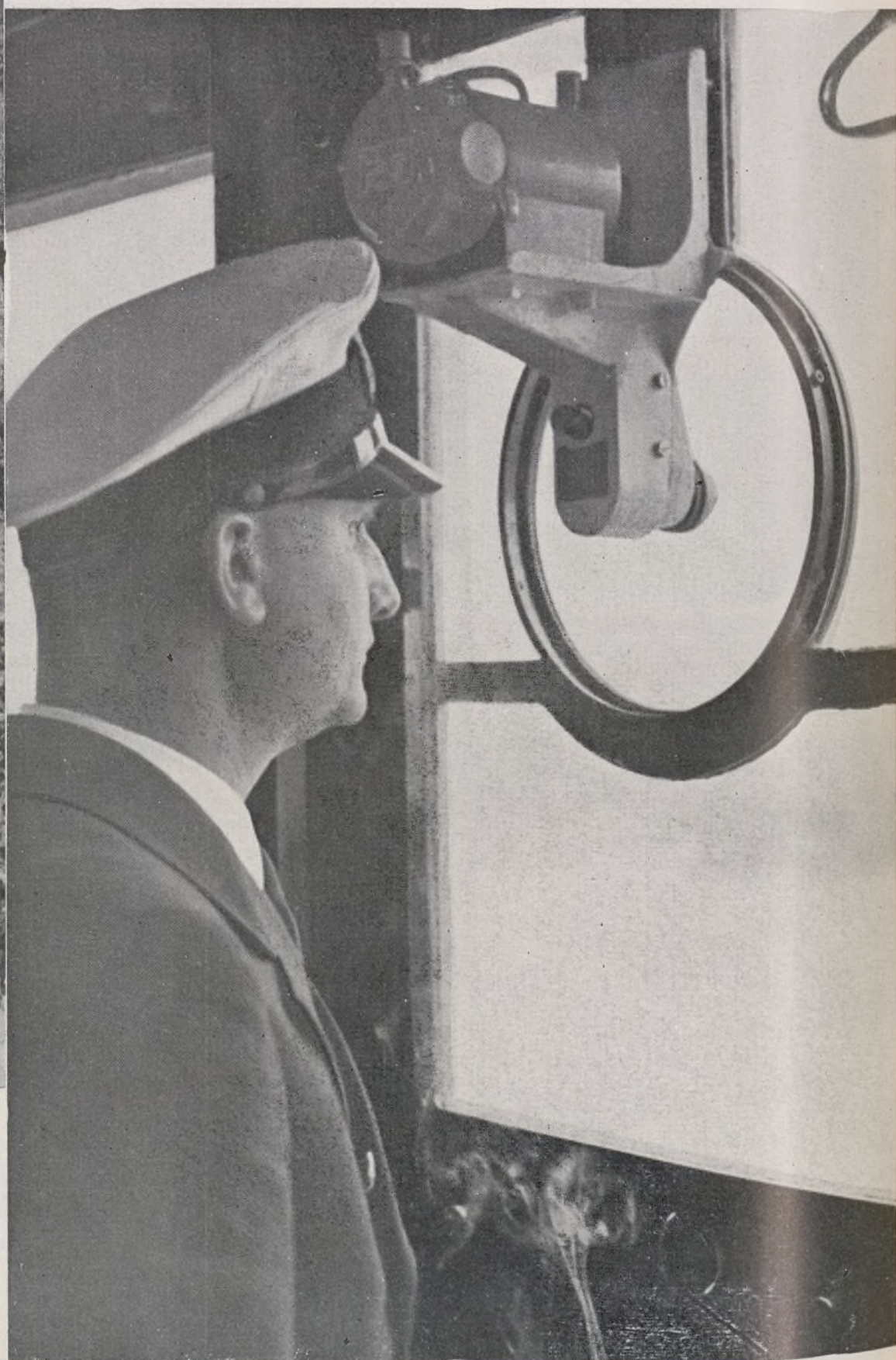
El puente de mando del nuevo buque alemán «Wilhelm Gustloff» ha sido equipado con un vidrio circular que tiene la particularidad de no empañarse nunca por malas que sean las condiciones meteorológicas; de este modo es posible dirigir siempre el barco desde el interior.
