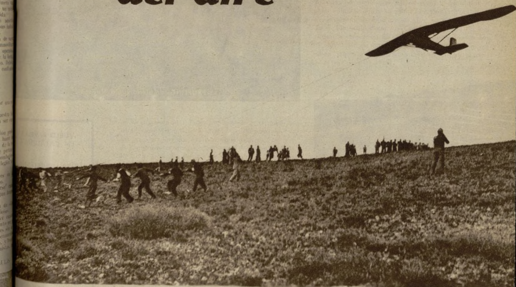
Lanzamiento de un «FALKE» mediante Sandow (cable de hilos de goma).
