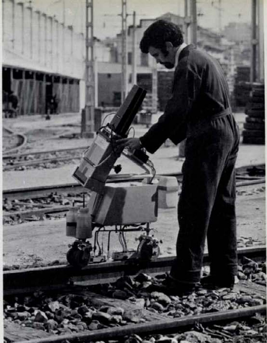
Aparato de ultrasonidos para verificación de carriles
