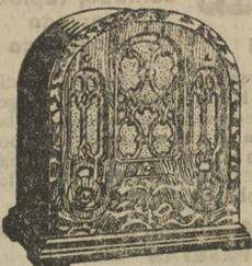
No es un moderno aparato universal sino un gran Superheterodino de 5 válvulas, para corriente alterna. Control automático de volumen, altoz electrodinámico. Gran selectividad, alcance y volumen. En lujoso cofre de madera, enteramente construido en las grandes fábricas ATWATER KENT.
