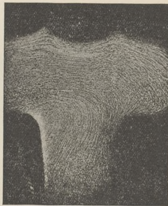
La misma pieza de la figura anterior forjada correctamente. Véase la perfecta orientación de las fibras.
