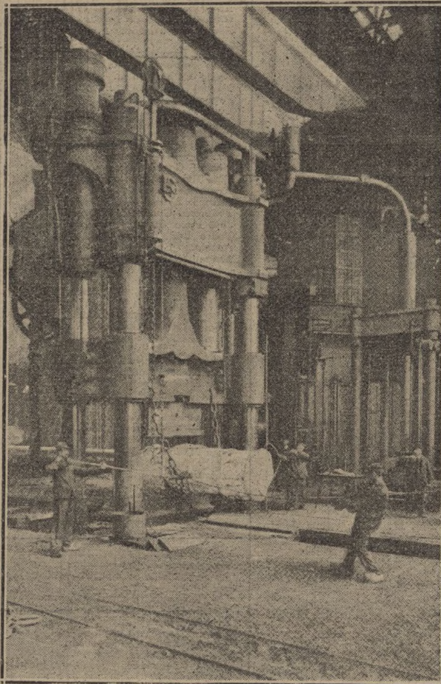
Prensa hidráulica de 4.000 toneladas que funciona en los talleres de fundición de cañones de la casa Krupp.
