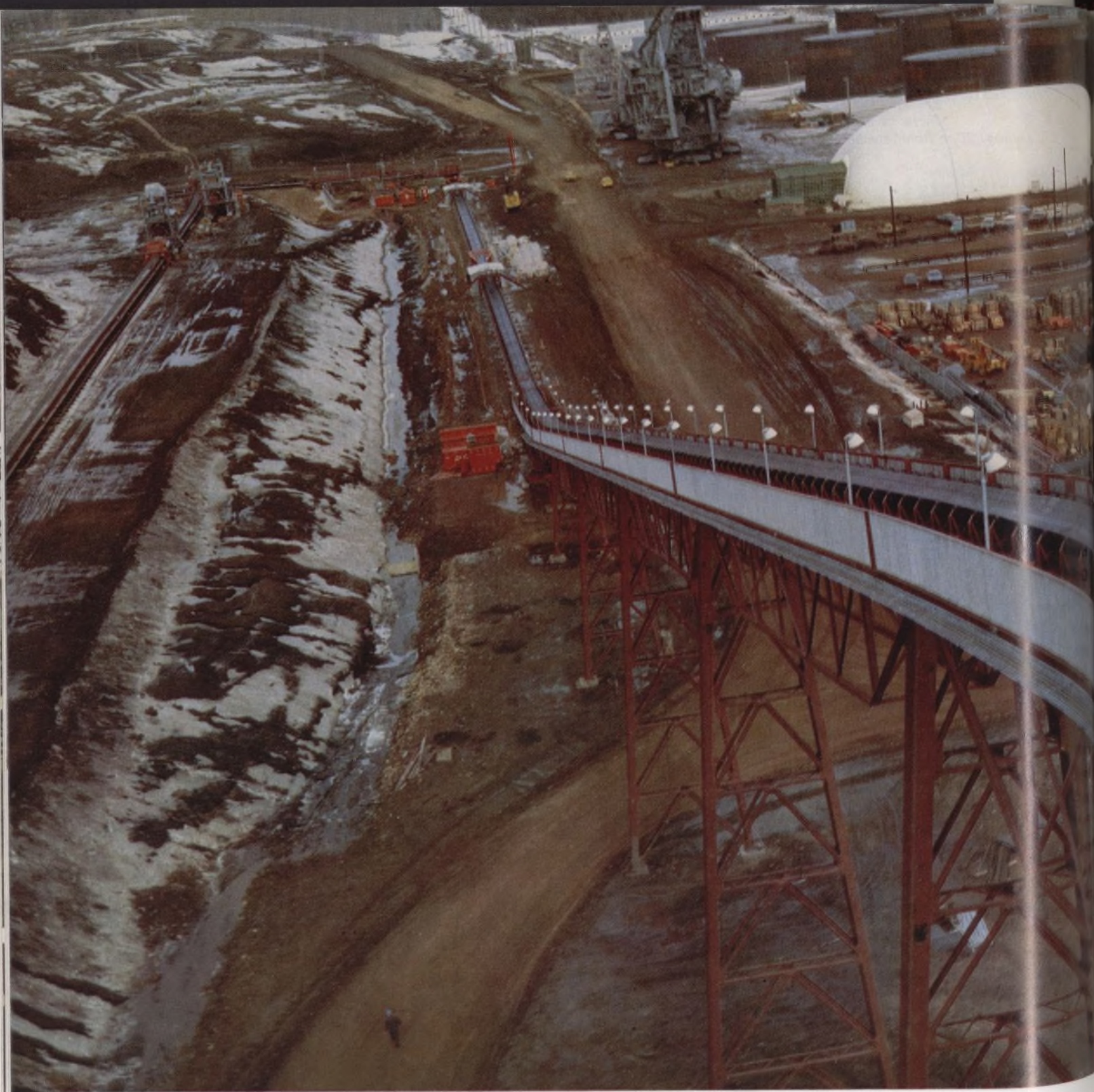
Bandanlagen in Kanada für den Transport von Ölsand unter schwierigsten Betriebsbedingungen (Temperaturbereich -55^{\circ} bis +40^{\circ} C)
