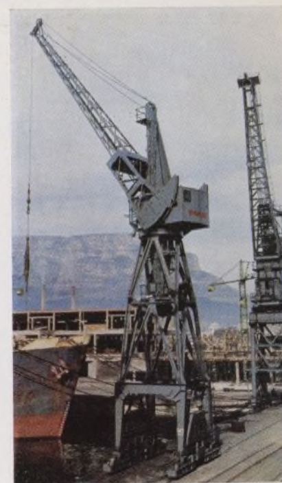
4-t-Stückgutkran im Hafen von Kapstadt — einer der 90 Krane, die z. Z. bei der Cranes South Africa für verschiedene Häfen in Süd-Afrika und Mozambique gebaut werden. Allein der Hafen Durban wird mit 42 DEMAG-Kaikranen ausgerüstet
