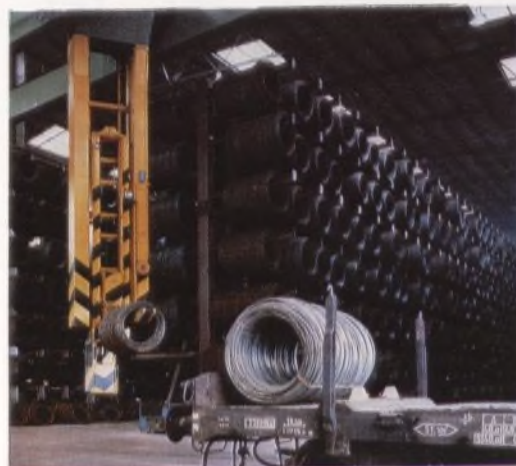
Vollnutzung des Raumes bei Zugriffsmöglichkeit zu jedem Drahtbund durch einen DEMAG-Schwergut-Stapelkran
