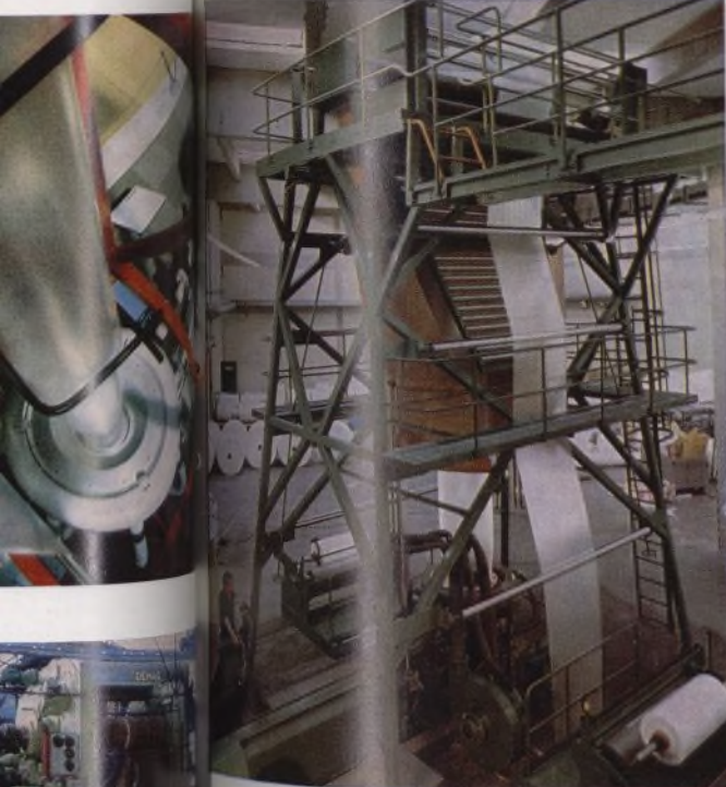
Für die kunststoffverarbeitende Industrie: Herstellung von Verpackungsfolien auf einer DEMAG-Blasfolienanlage
