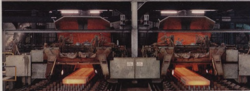
Stapelanlage im Anschluß an eine z. Z. in Montage befindliche DEMAG-Universalträgerstraße
