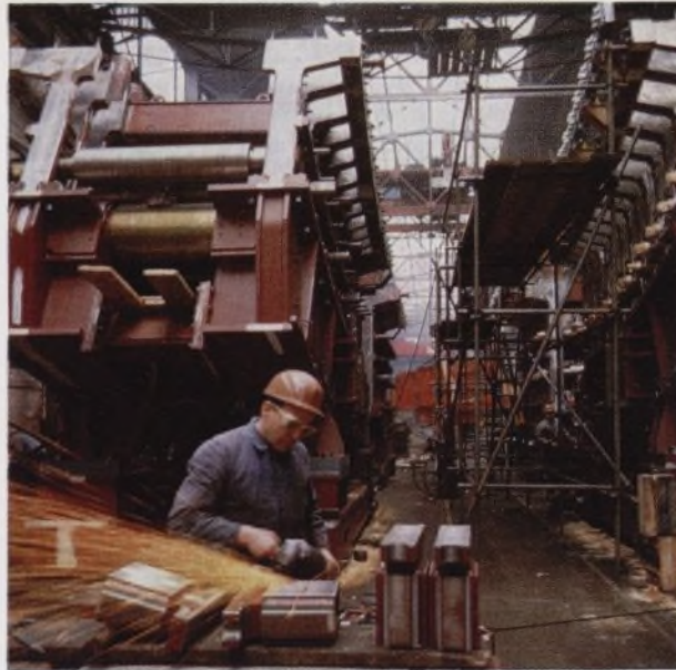
Werkstattmontage einer Strang-Richt- und -Ausziehmaschine für eine Breitbrammen-Bogengießanlage
