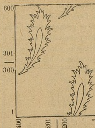
Fig. 1.—Para el taladro de los 300 primeros cartones, leer desde la primera aguja, á partir del primer renglón vertical, al 400. Para los 300 últimos cartones, leer desde la primera aguja, á partir del renglón 201 al 400, y continuar desde el primer renglón al 200.
