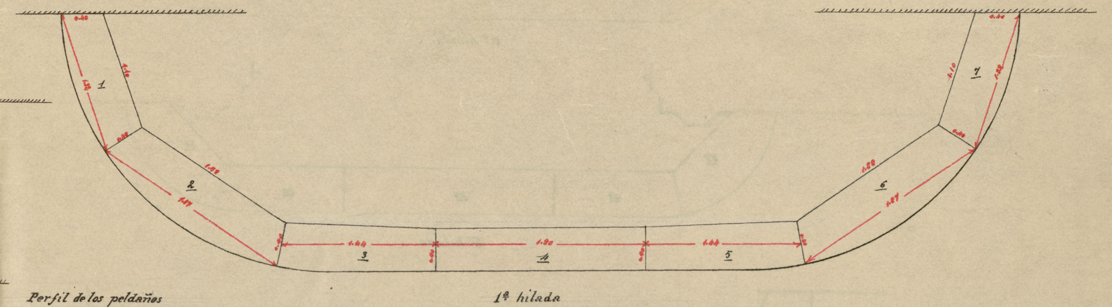
Perfil de los peldaños (1ª hilada 1ª de 0.25 de altura, en línea recta)
