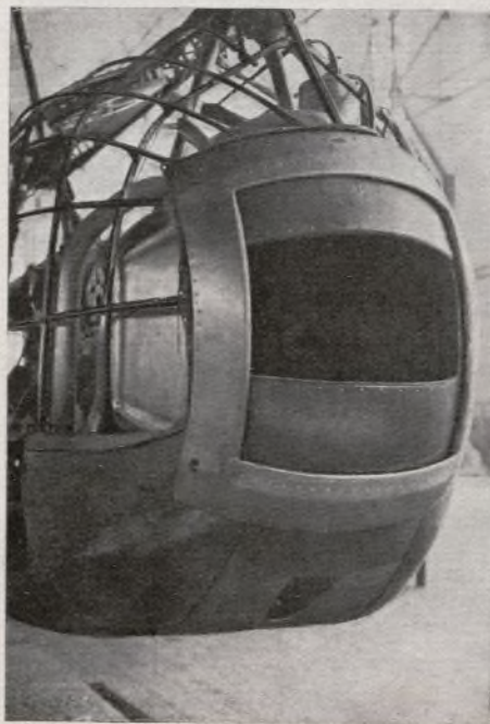
La refrigeración de los motores del Zeppelin: Ventanillas que abren ó cierran la entrada de aire á los radiadores
