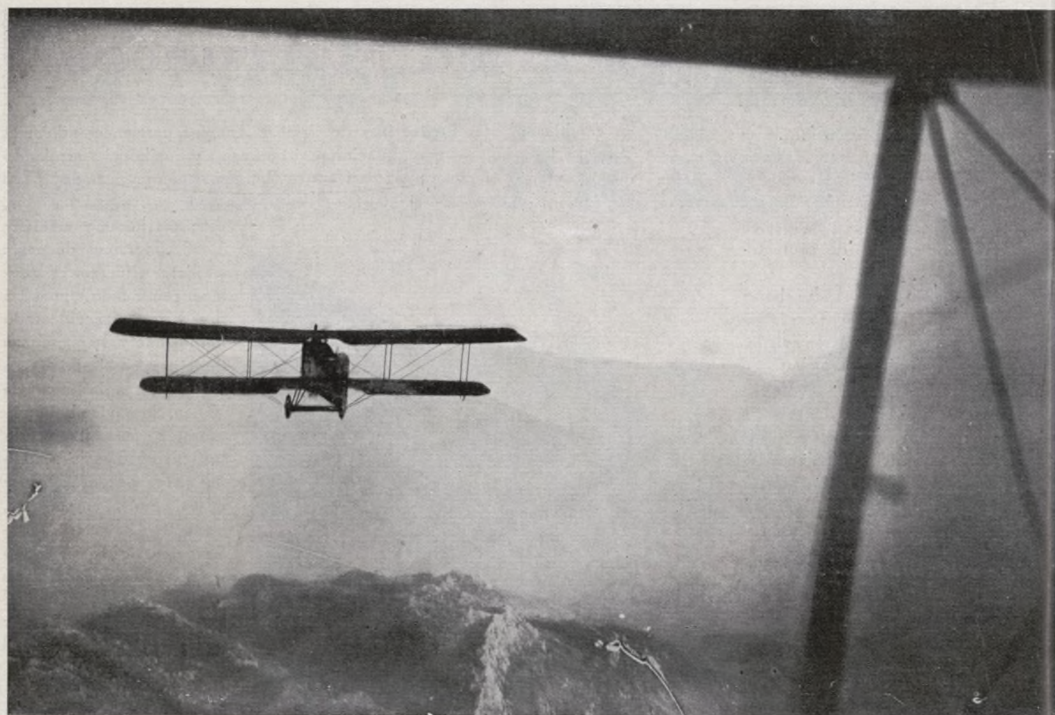
Biplano «Breguet», en vuelo; excelente aparato de bombardeo, con motor «Fiat» 300 HP; lleva aparatos lanzabombas para 15 proyectiles, ametralladora, telegrafía sin hilos y aparato fotográfico
