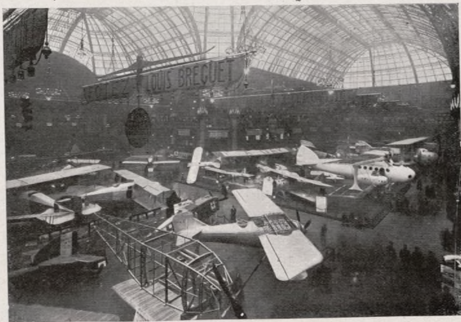
En primer término el esqueleto central del «Leviathan», de Breguet, con sus cuatro motores en dos grupos acoplados á una sola hélice
