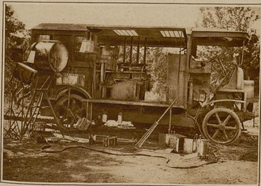
Uno de los grupos Electro-Móviles de 600 amperes que posee «Omniun Cine».
