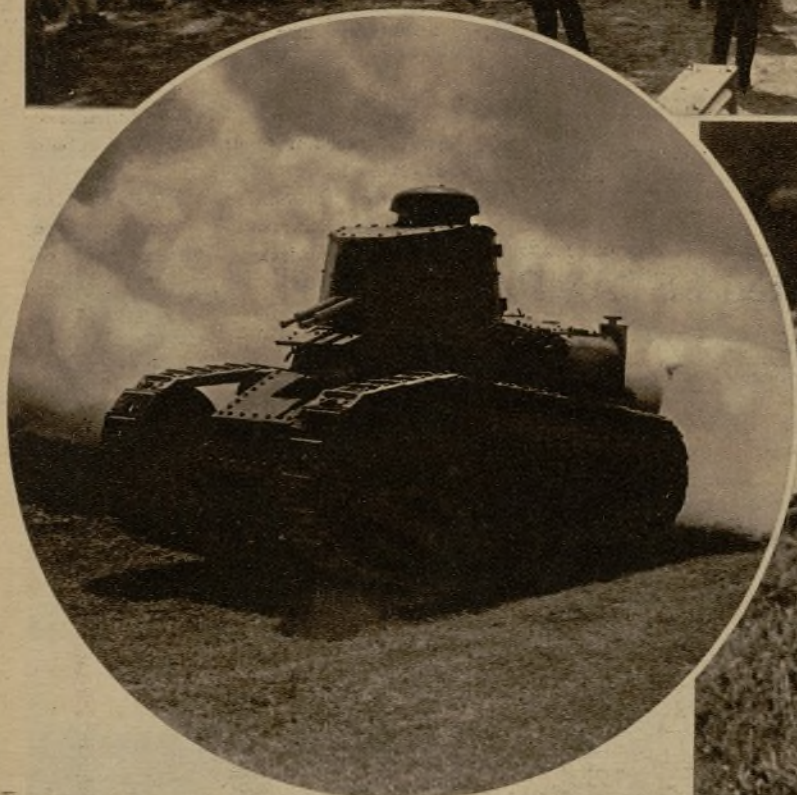
Uno de los tanques lanzadores de humo que fueron utilizados en las maniobras para ocultar los avances de las fuerzas. A la derecha, soldados provistos de caretas contra los gases atrincherados tras una loma
