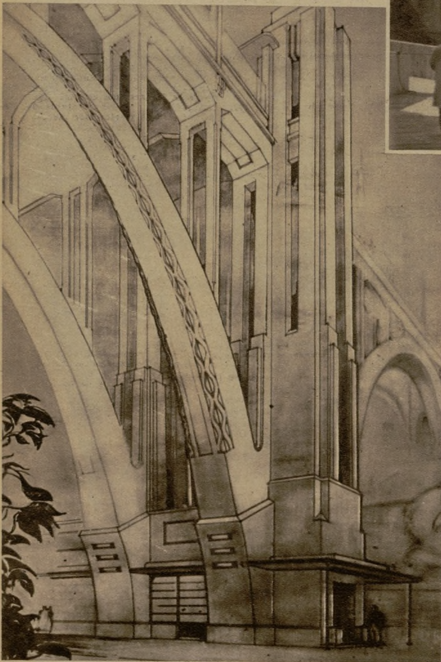
Esquema de las columnas centrales del futuro Viaducto, en las que estarán instalados ascensores para el servicio público. En la base se montarán puestos de periódicos y quioscos de limpieza
