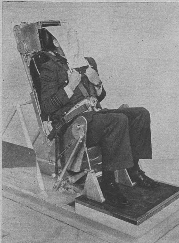
NO ES LA SILLA ELECTRICA. —No se trata de un condenado a muerte, sino de un piloto de la R. A. F. sentado en el «asiento lanzable» para aviones supersónicos construido en Inglaterra. Cuando el piloto tira con ambas manos de la visera o persiana que cubre su cara, el asiento sale «disparado» del avión por medio de una carga explosiva. Esta es la única manera de lanzarse en vuelo desde un avión supersónico, pues no hay hombre capaz de realizarlo por sus propios medios.
