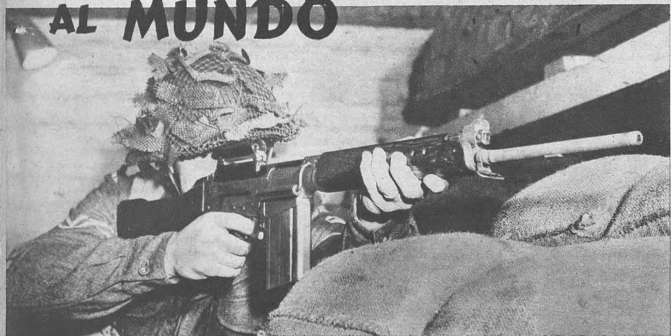
RIFLE BELGA.—Un fusilero inglés prueba el nuevo rifle de carga automática fabricado por la industria de armamentos belga. Fue ideado para disparar proyectiles del 26, de velocidad lenta, pero después descendió de categoría y finalmente dispara balas del 30, facturadas por el empuje de la pólvora en gran velocidad.
