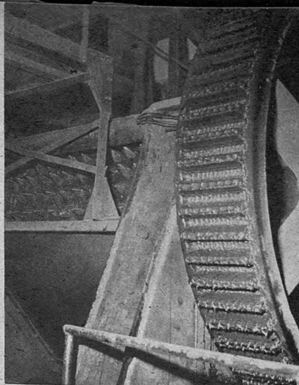
Grandes y modernos molinos trituran el mineral antes de pasar a los elevadores que han de conducirle a la fase de destilación
