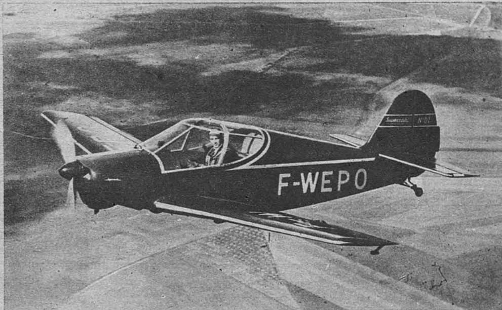
AVION PARA DOS PLAZAS Y VARIOS USOS.—Este avión «Supercab» puede utilizarse al mismo tiempo como aparato de instrucción, turismo y deportes. Consume siete litros de gasolina por cien kilómetros y costará dos millones y medio de francos.—(Foto Associated Press.)
