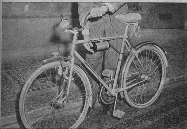
BICICLETAS CON RADIO. —He aquí un nuevo modelo de radio, adaptable a bicicletas; el receptor aparece adosado al cuadro, el altavoz va sujeto al manillar, las baterías están situadas bajo el asiento y la antena arranca de la rueda delantera. Patentado en Suecia; su coste ronda los 35 dólares.—(Foto Torremocha.)
