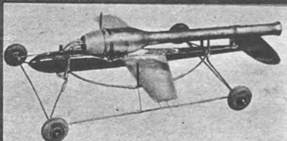
Aeromodelo a reacción, de la E. C. A. de Madrid, récord del mundo en 1952, con 215 kilómetros por hora
