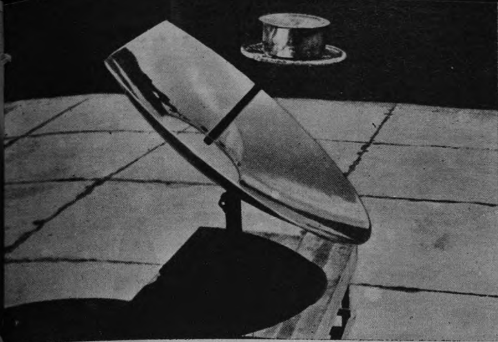
Hornillo solar utilizado en la India. Los rayos solares hacen hervir en diez minutos el agua del recipiente
