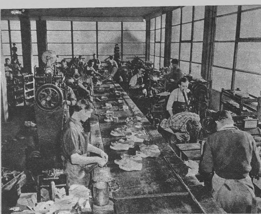
Aquí han desaparecido los habituales y lentos medios de transporte. Una cinta hace todos los traslados en la sección de montaje
