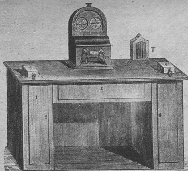
Mesa de aparatos telegráficos del primer tipo utilizado en España en el año 1855
