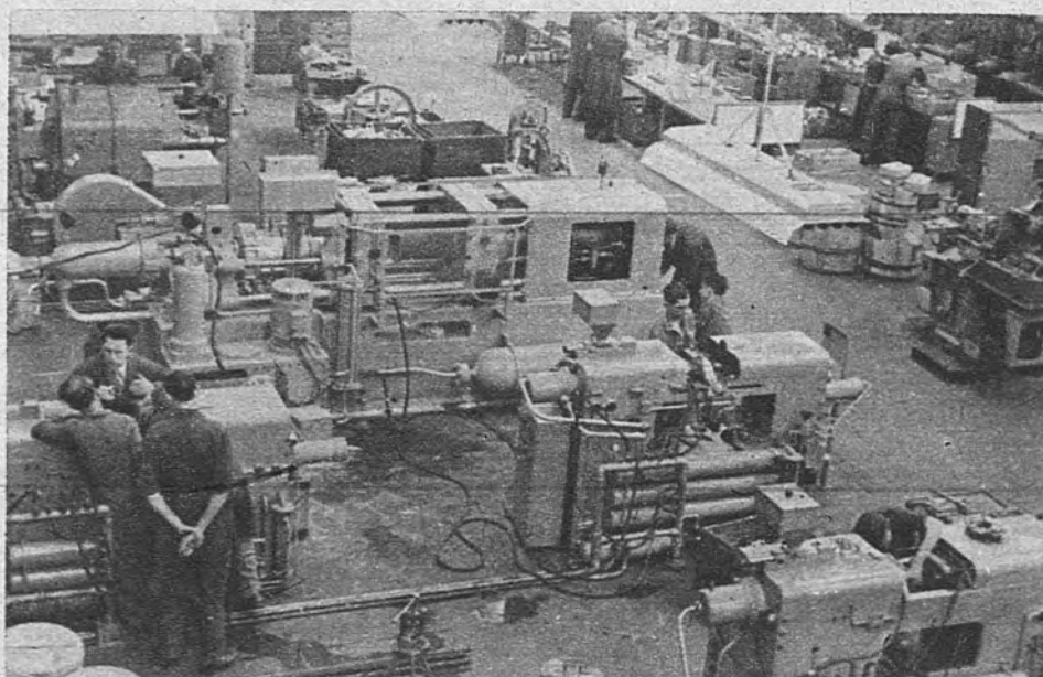
La máquina grande es para el modelado de piezas por inyección. Está en montaje en el taller de plásticos y trabajará con termoplásticos
