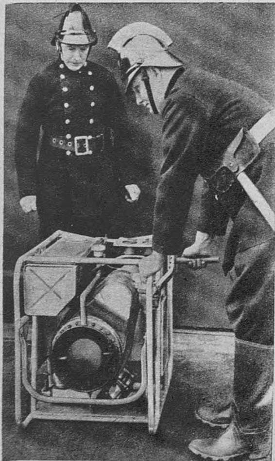
Foto izquierda: Unidad Sigmund-Róver para extinción de incendios. Suministra 2.300 litros por minuto a siete atmósferas con una altura de succión de diez pies. A la derecha: Sección ilustrativa de la turbina de gas 1 S/60
