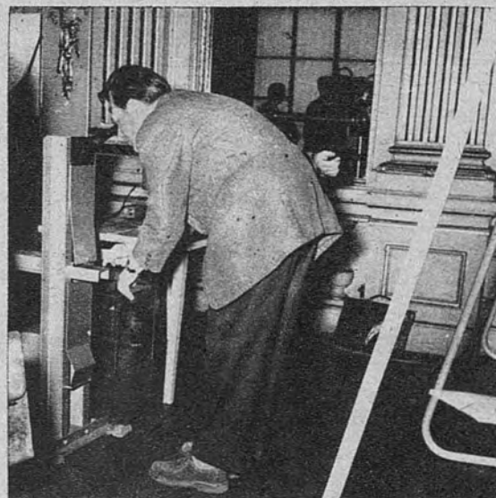
DESPLAZAMIENTO DE ONDAS. —Con este aparato pueden medirse los desplazamientos de ondas con una exactitud de diezmilésima de milímetro
