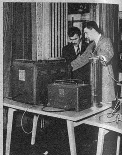
UN "SONAR". —Por medio de ondas acústicas, el "sonar" mide distancias de forma parecida al "radar". Se emplea en el sondeo de fondos marinos
