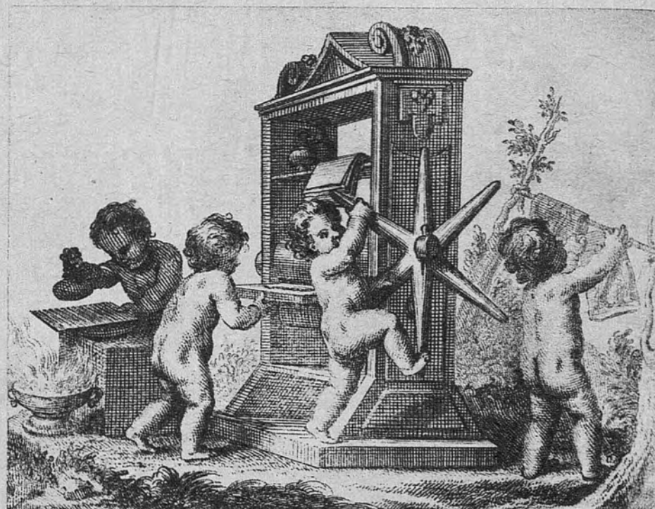
Este encantador aguafuerte, que "Ant. Gonz. inventó y Palomino grabó", relata todo el proceso de la obtención de reproducciones: calentamiento de la plancha, entintado con el tampón especial, colocación de la plancha en el tórculo, paso del cilindro, presionando el papel húmedo y secado de las pruebas. El procedimiento no ha cambiado esencialmente. El grabado superior reproduce una plancha de Roelas, la única que se conserva catalogada, y cuya adquisición, de manos de un particular, supuso el desembolso de buen número de miles de pesetas
