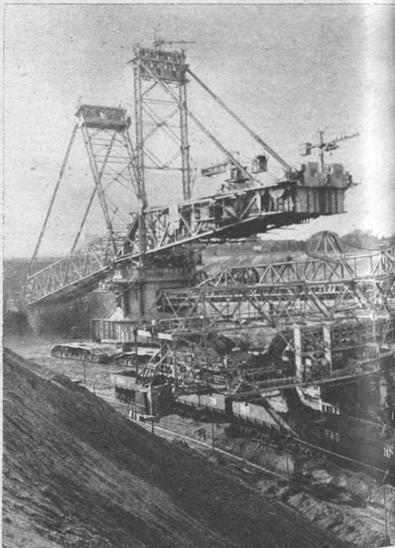
DRAGADORA GIGANTE. —Alemania posee la mayor máquina de dragado existente en el mundo. Instalada para trabajar en unos pozos de lignito cercanos a Colonia, esta dragadora puede extraer tres mil metros cúbicos de tierra al día. A pesar de ello, bastan cinco hombres para manejarla. (Foto Cifra-U. P.)
