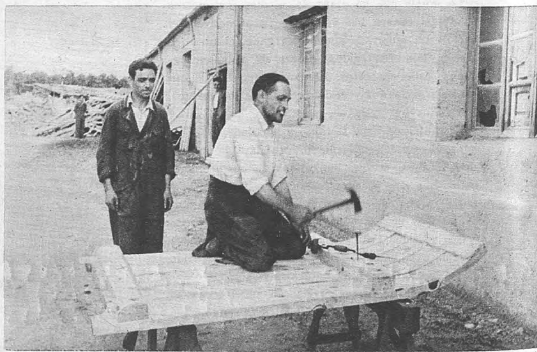
SECRETO PROFESIONAL. —El trillo espera esa armazón interior que justifica su presencia. Y el artesano cumple su misión con ayuda de unos largos clavos, capaces de sostener unidas las partes de la pieza. Es difícil, pero se consigue.
