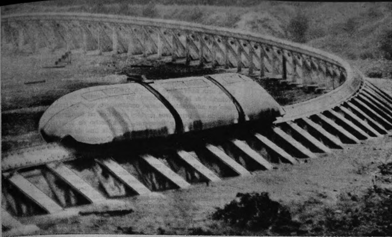
FERROCARRIL. —Sobre un solo raíl, toma una curva a sesenta millas por hora el nuevo modelo de ferrocarril construido por los ingenieros alemanes Hinsken y Holzer, en Fuenhlinger, cerca de Colonia.—(Foto A. P.)
