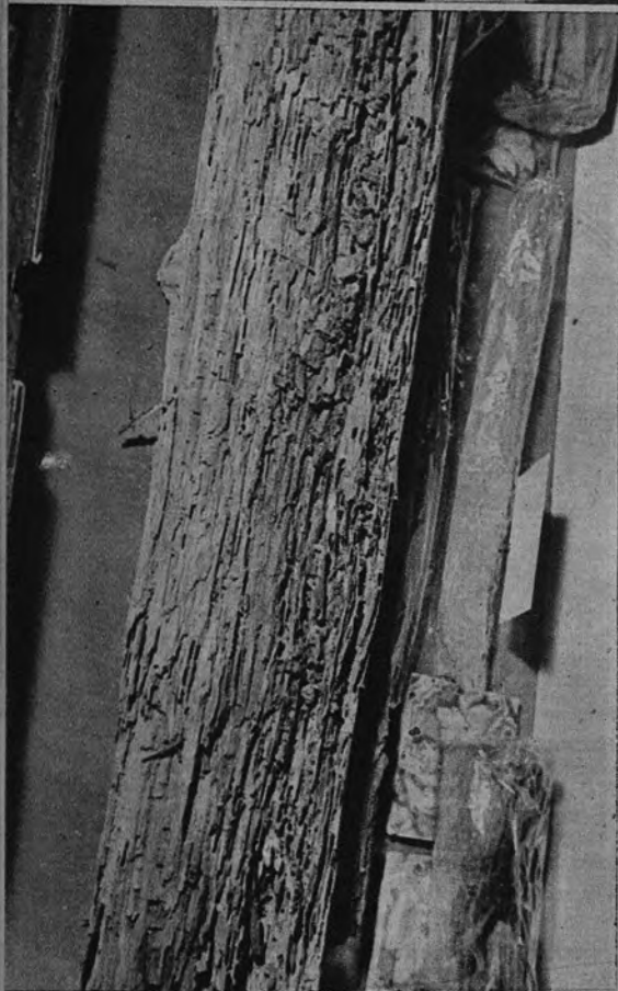
Muestras de vigas atacadas en Madrid. Véase especialmente la cabeza de viga totalmente cortada. Es típica e inconfundible la destrucción en forma laminar: siempre que puede la hormiga prescindir de la veta oscura, compacta e imposible de digerir, mientras que devora ávidamente la madera blanca y esponjosa.
