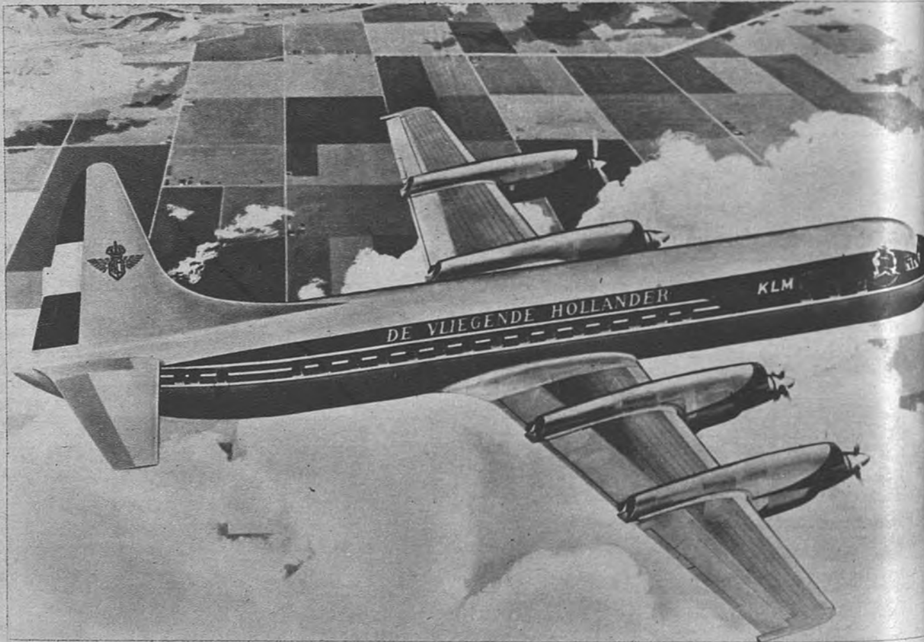
AVIACION COMERCIAL. — Uno de los aparatos de transporte a turbohélice que se preparan con destino a la aviación comercial. El nuevo aparato podrá desarrollar una velocidad de setecientos cincuenta kilómetros por hora y permitirá la adopción de una serie de dispositivos e instalaciones para la mayor comodidad del viajero. Las características de este avión son: envergadura, 29 metros; fuselaje, 30; altura total, 10
