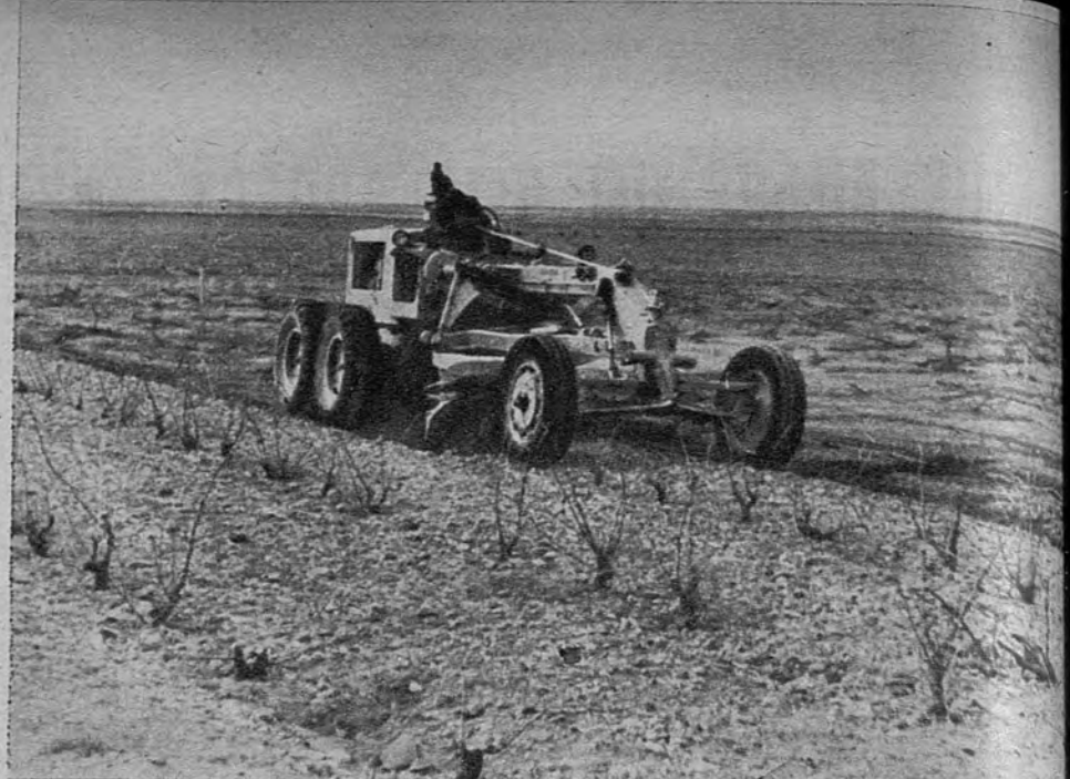
La motoniveladora tiene la misión de refinar los terrenos que han sido ya nivelados. Circunstancialmente vemos aquí una de estas máquinas en la operación rapidísima de arrancar las cepas de un viejo viñedo monegrino
