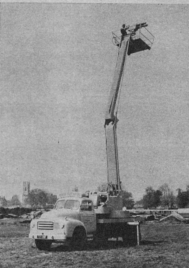
PLATAFORMA. —Para el mejor servicio de la televisión ha comenzado a utilizarse en Inglaterra este modelo de plataforma móvil, que permite a las cámaras toda serie de movimientos ascendentes y horizontales.—(Foto Cifra Gráfica.)
