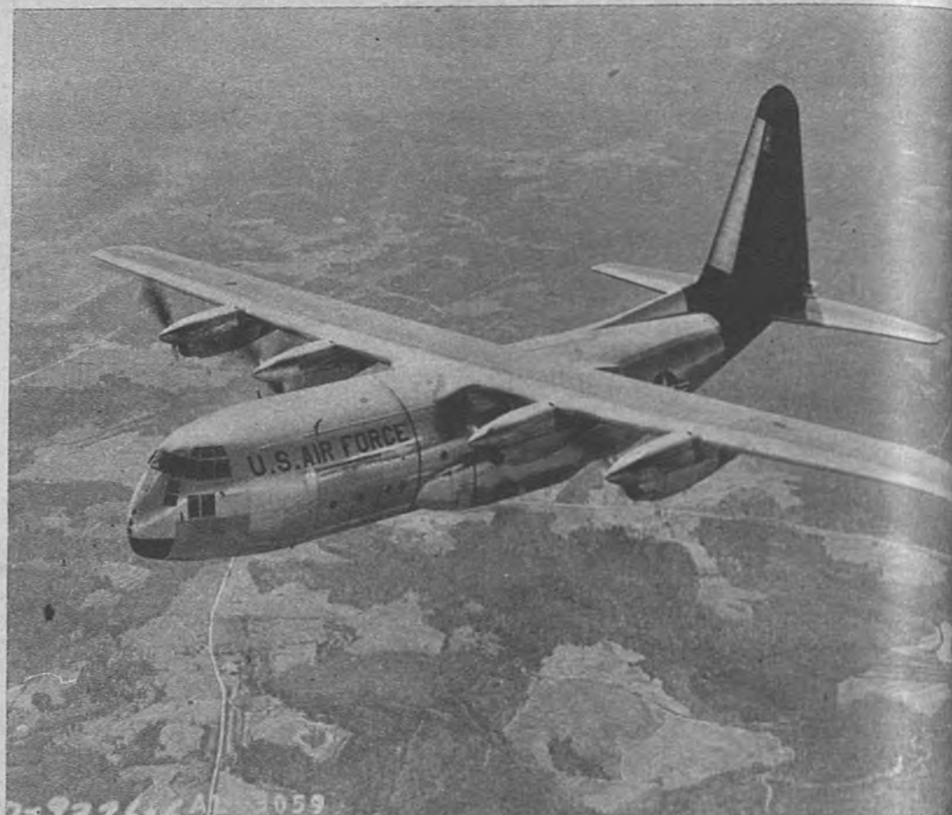
NUEVO AVION GIGANTE. —El nuevo avión gigante a turbohélice «Lockheed Hércules C-130A» regresa a su base de Marietta (Georgia) después de haber realizado su primera prueba climática en Eglin, base de las fuerzas aéreas de los Estados Unidos
